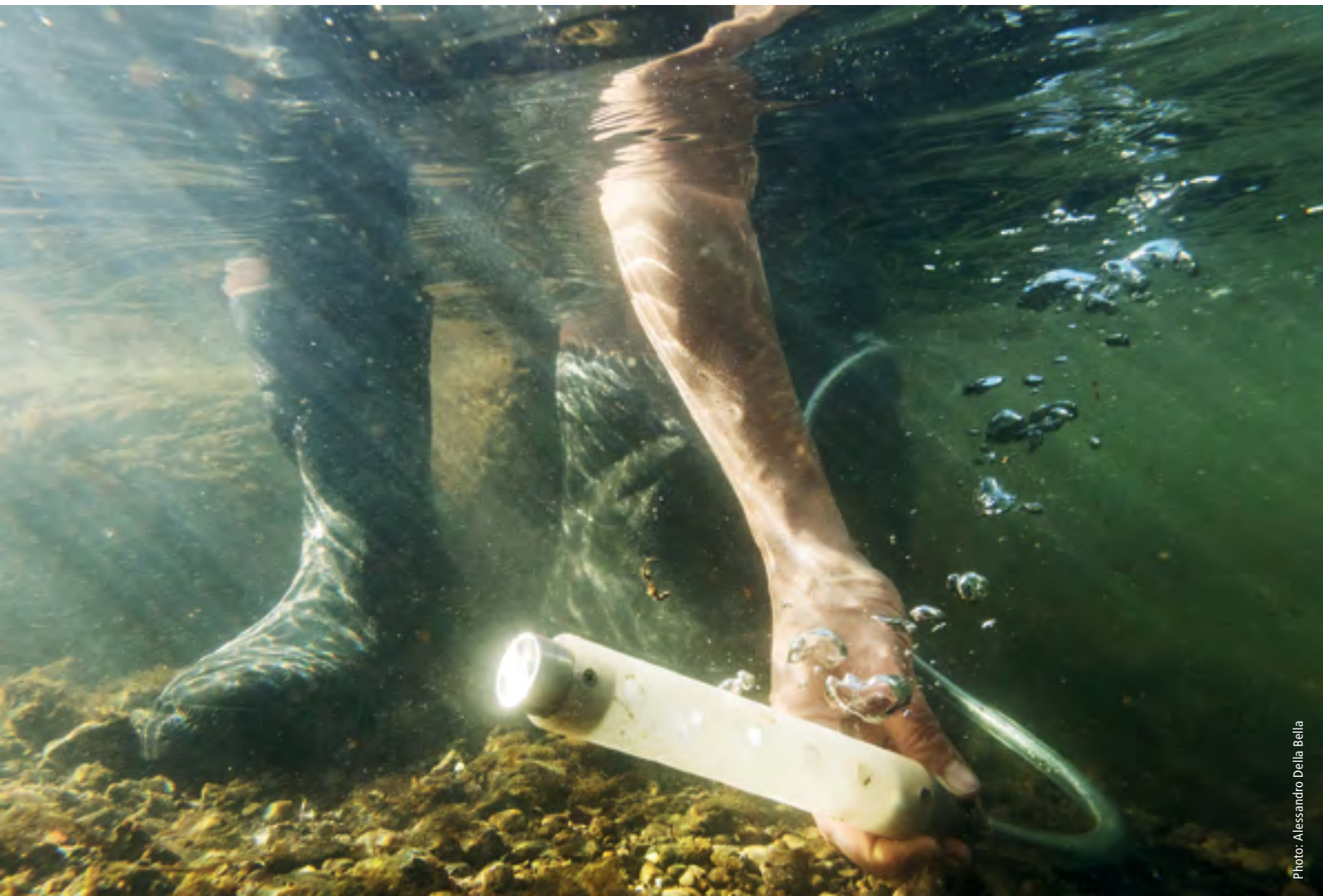
▼ Figure 4 : Mise en place d'un échantillonneur actif. La qualité de l'échantillonnage est décisive pour la pertinence des résultats d'analyse.
